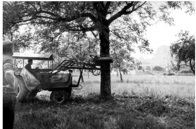
Secoueuse hydraulique montée sur la fourche du tracteur - 1969
